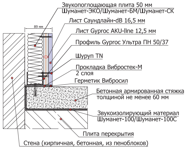
3.1.3 Угловое примыкание облицовки стены на независимом каркасе 50 мм к панелям ЗИПС на стене и дверному проему
